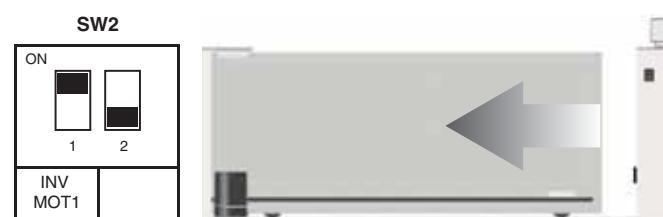
Regulación de **SW2** para obtener una apertura hacia la **DERECHA** (vista interna)
